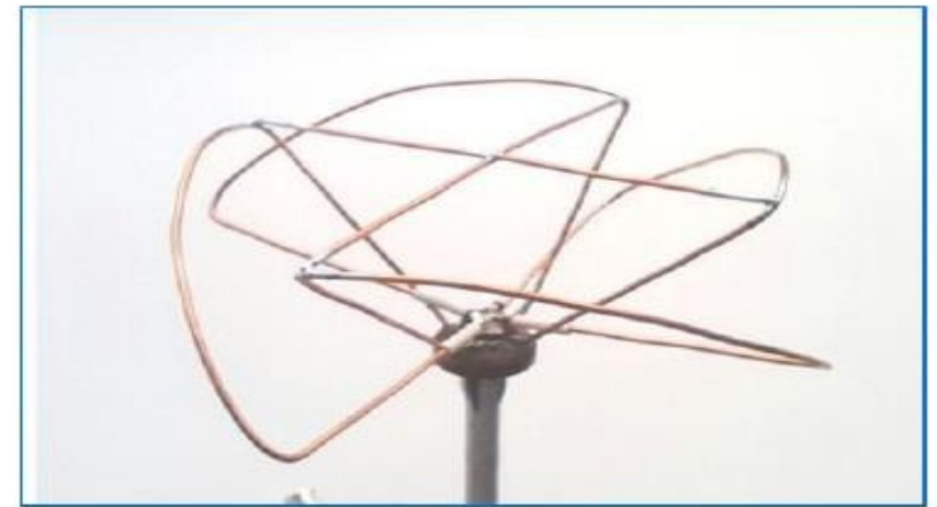
Изотропная антенна круговой поляризации «Квазишунтовой клевер» 1 ГГц.
