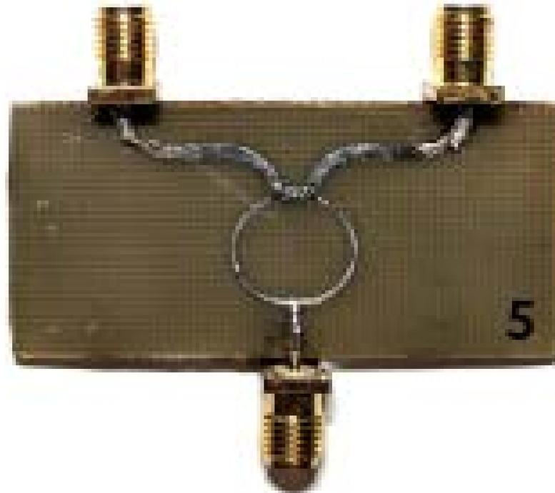
Реализация сумматора конструкции Уилкоясона на микрополосках.
